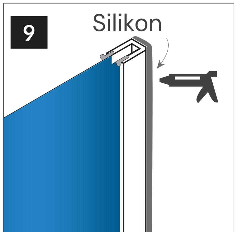
Alle Teile sind getrocknet, entfettet, und der Abstand von 3 mm zwischen dem festen Glas und dem Boden wird mit Silikon gefüllt, das im Lieferumfang enthalten ist. Ebenso wird jede Unregelmäßigkeit zwischen dem U-Profil und der Wand innen mit Silikon abgedichtet. (Siehe Abb. 9 und 10.)
