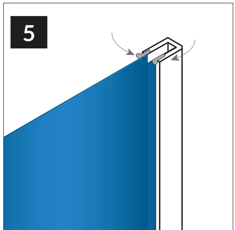
Anschließend wird das Glas im U-Profil auf beiden Seiten mit Dichtungen gesichert. (Siehe Abb. 5.)
