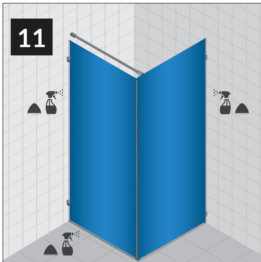
Befestigen Sie das Schwellenprofil unter der Tür und platzieren Sie die Dichtung unter dem Glas. Die Schrauben der Scharniere sollten nach 2 bis 3 Tagen erneut angezogen werden.
